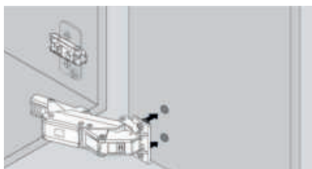
2 / Insertion de la charnière dans son emplacement.
